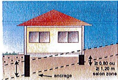
**Adapter les fondations :** prévoir des fondations continues - armées et bétonnées à pleine fouille - d'une profondeur d'ancrage de 0,80 à 1,20m en fonction de la sensibilité du sol; assurer l'homogénéité d'ancrage des fondations sur les terrains en pente; éviter les sous-sols partiels; préférer les sous-sols complets, radiers ou planchers sur vide sanitaire plutôt que les dallages sur terre-plein.
